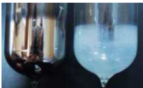
Nepoškodovana in poškodovana cev
